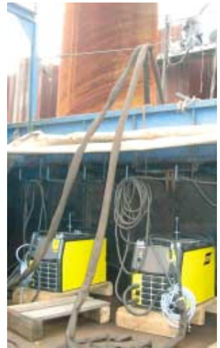
▲ AristoMig 400 mit abgesetztem Vorschubkoffer AristoFeed 48 ▼
