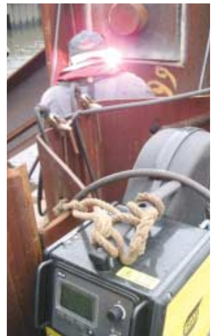
▲ AristoMig 400 mit abgesetztem Vorschubkoffer AristoFeed 48 ▼
