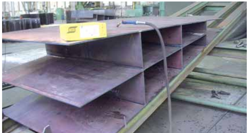
Rotorsegment geschweißt mit OK AristoRod 13.26
