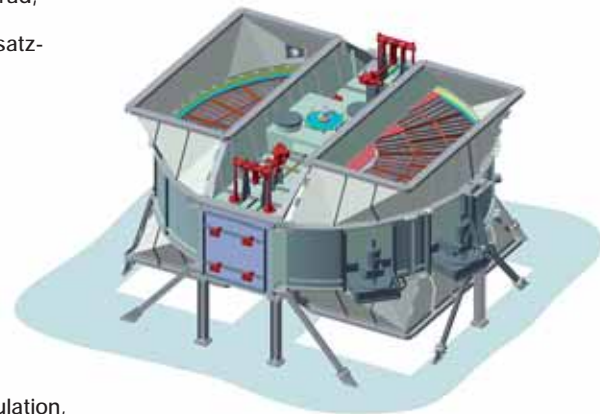
4. „Ljungström“-Luft- und Gasvorwärmer der Bauart „Air Preheater Europe“
