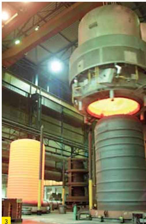
3. Schutzgasglocke und Haubenglühöfen Werksfoto: ESAB
